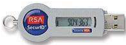
Obrázek 2: Token RSA SecurID SID800 (převzato z [7])
