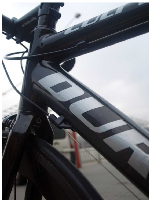
Obr. 18 – Skořepinový karbonový rám [30]
