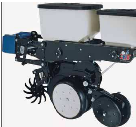
Obr. 9: Výsevní jednotka Kinze - Model 3500. [17]
