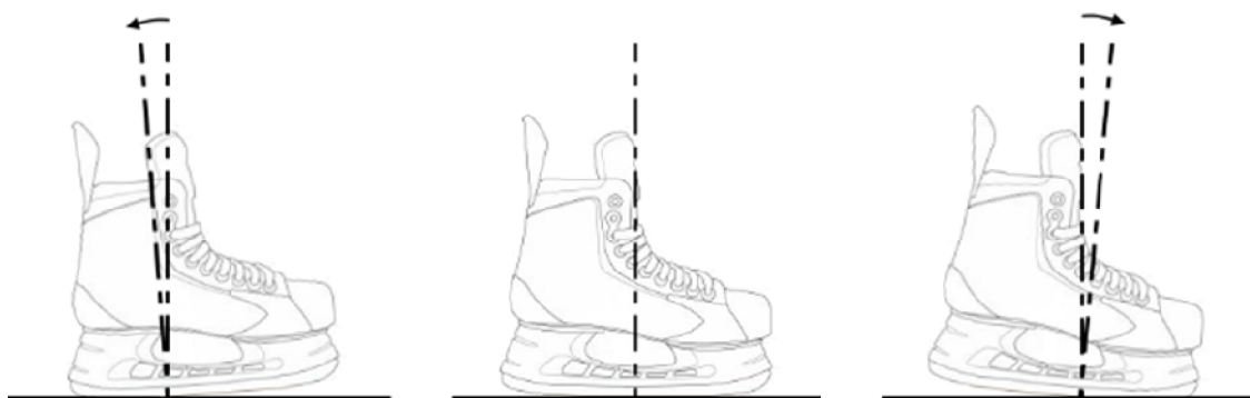
Obr. 1.10 – Sklon nože (boční pohled)
