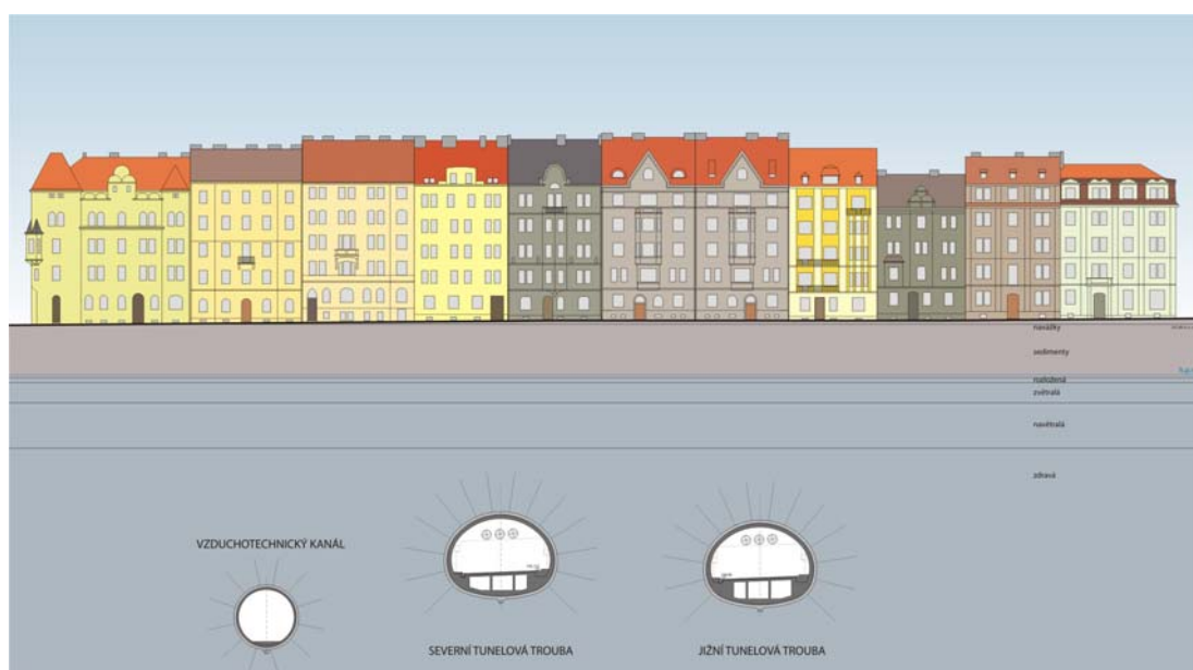
Obr. 04: Řez ulicí Na Výšinách, Praha, Letná (zdroj: fotoarchív Satra)
