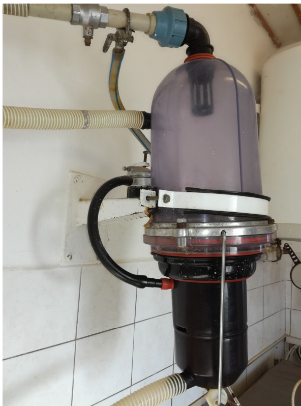
Obr. 18 – Sběrná nádoba s přerušovačem podtlaku – farma A
