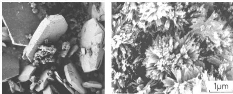
Obrázek 5: SEM snímky (a) portlanditu (b) C-S-H gelu [15]
