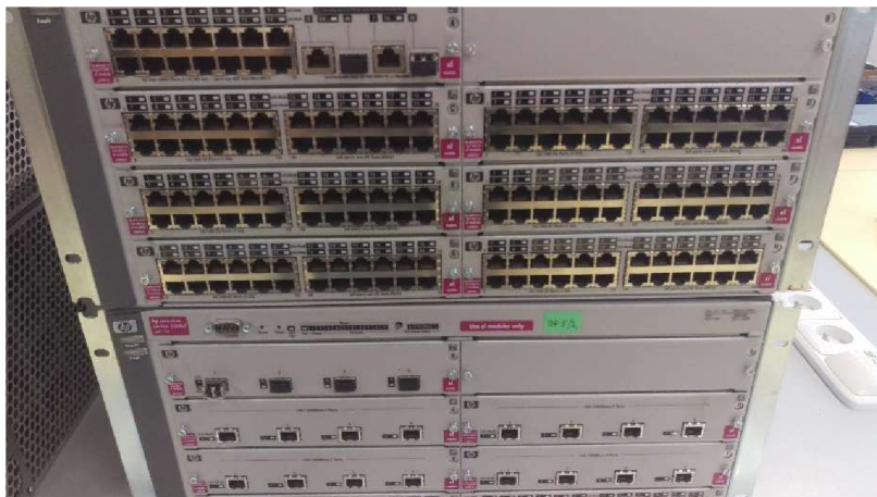
Obrázek 22: Modulární switch HP (vlastní tvorba)
