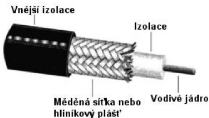
Obrázek 2: Koaxiální kabel (6)
