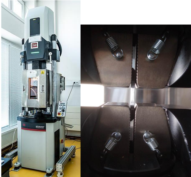
Obr. 62 Použitý stroj pro únavové testy Acumen 12 a vzorek upnutý v čelistech
