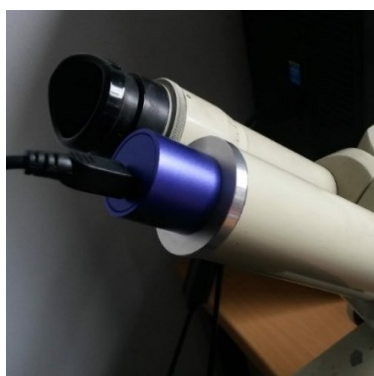
Obrázek 29: Kamera Levenhuk umístěná v tubusu polariskopu na místo okuláru
