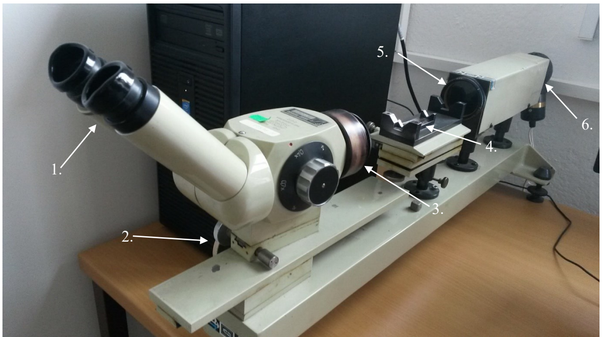
Obrázek 17: Polariskop: 1. okulár; 2. makrošroub; 3. polarizátor; 4. prizma pro umístění tyče; 5. polarizátor; 6. lampa
