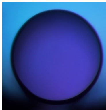
Obrázek 41: Příklad laserové tyče bez poruchy umístěné mezi zkříženými polarizátory
