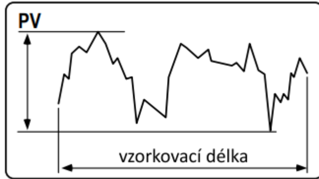
Obrázek 26: Ilustrace chyby peak-to-valley převzato a upraveno z [47]
