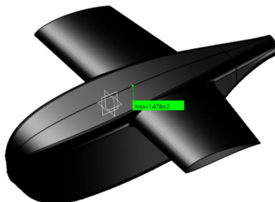
Obr. 10-1 Zistenie plochy gondoly a centropoplánu pomocou programu CATIA V5R20
