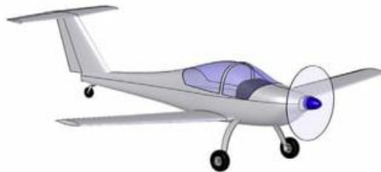
Obr. 2-24 Usporiadanie podvozku s ostrohovým kolesom [24]
