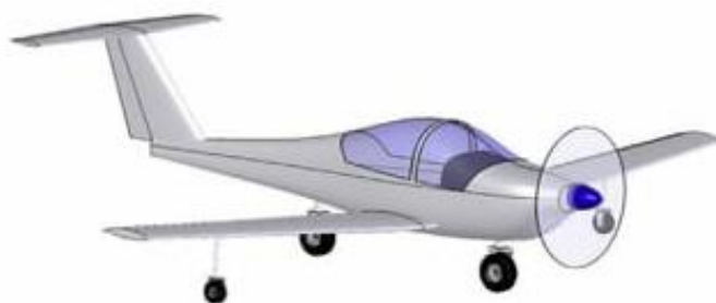
Obr. 2-26 Usporiadanie tandemového podvozku [24]
