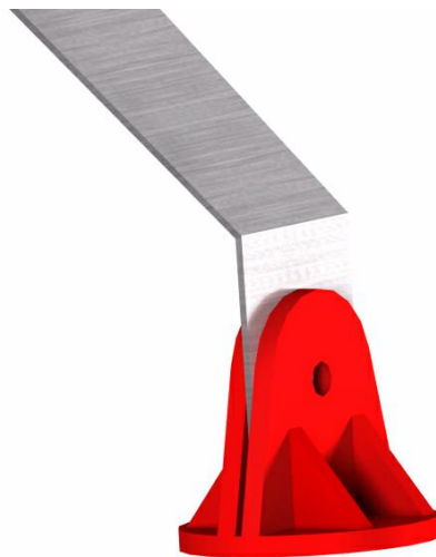
Obr. 9-2 Návrh podložiek pre pristávanie vytvorený v programe CATIA V5R20
