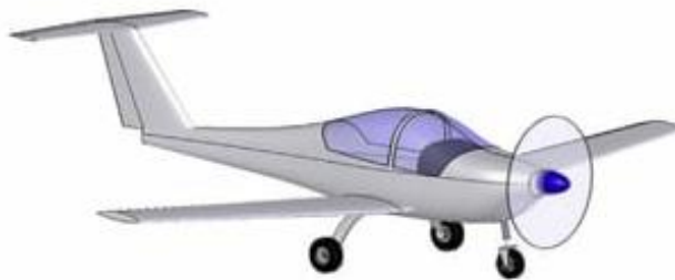
Obr. 2-25 Usporiadanie podvozku s čelným kolesom [24]
