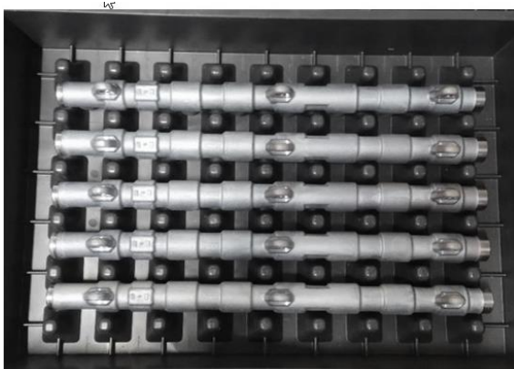
Obr. 6 Vodorovné zakládání railu [3]
