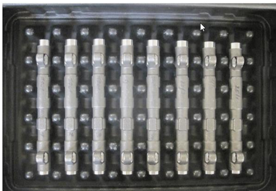
Obr. 5 Svislé zakládání railu [3]
