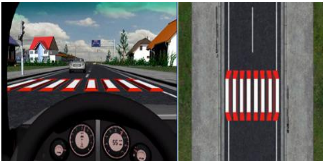
Obrázek č. 23 – 3D zvýraznění přechodů - simulace
