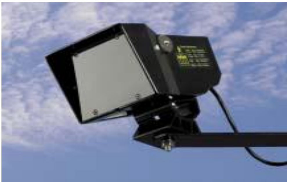
Obrázek č. 19 – Dynamické chodecké detektory
