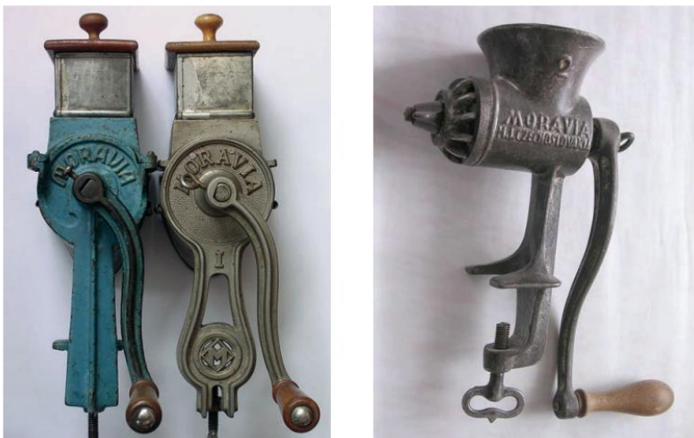
Obrázek č. 11 – Mlýnky na strouhanku a masořezka označené nápisem MORAVIA, zdroj: interní podklady společnosti
