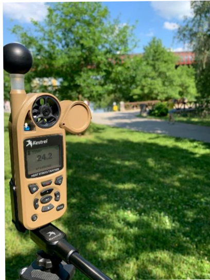
Obrázek 7 Foto přístroje Kestrel 5400, který byl využit při měření
