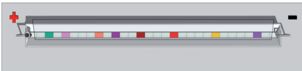
Obrázek 5: Schéma systému mikropreparativní izoelektrické fokusace [31]
