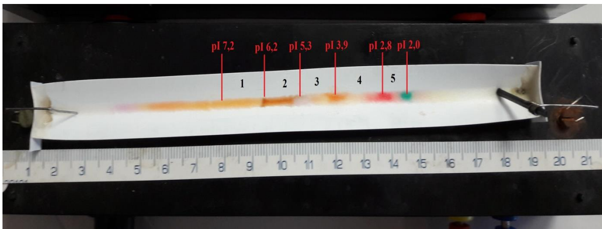
Obrázek 27: Koryto s nadávkovaným roztokem albuminu o koncentraci 2,5 mg/ml a pI markery po 24 hod fokusace
