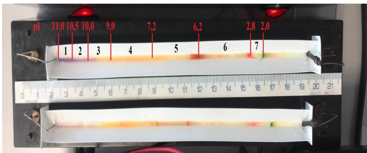
Obrázek 18: Koryta s nadávkovaným roztokem cytochromu c o koncentraci 1 mg/ml a pI markery po 24 hod fokusace
