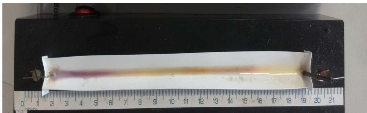
Obrázek 15: Koryto s nadávkovaným roztokem cytochromu c o koncentraci 1 mg/ml a pI markery po 3 hod fokusace
