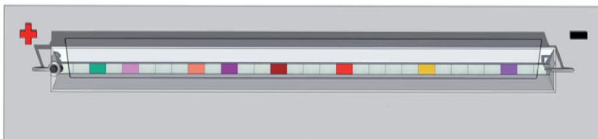
Obrázek 5: Schéma systému mikropreparativní izoelektrické fokusace [31]
