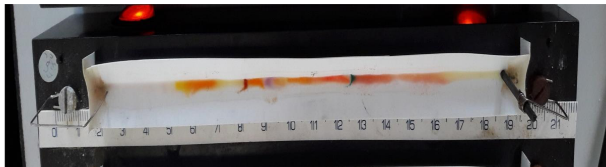
Obrázek 26: Koryto s roztokem cytochromu c o koncentraci 2,5 mg/ml a pI markery po 24 hod fokusace
