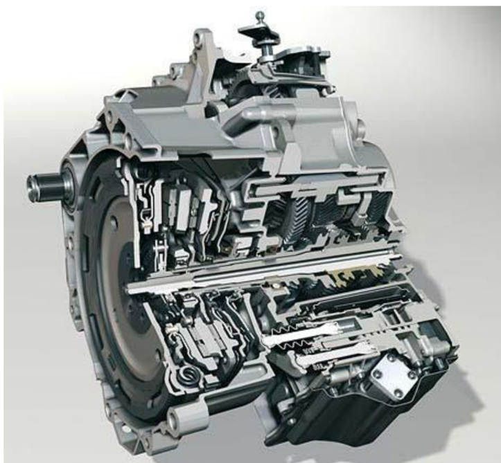
Obr. 4.5 Přebodovka DSG-7 pro příčnou zástavbu [22]
