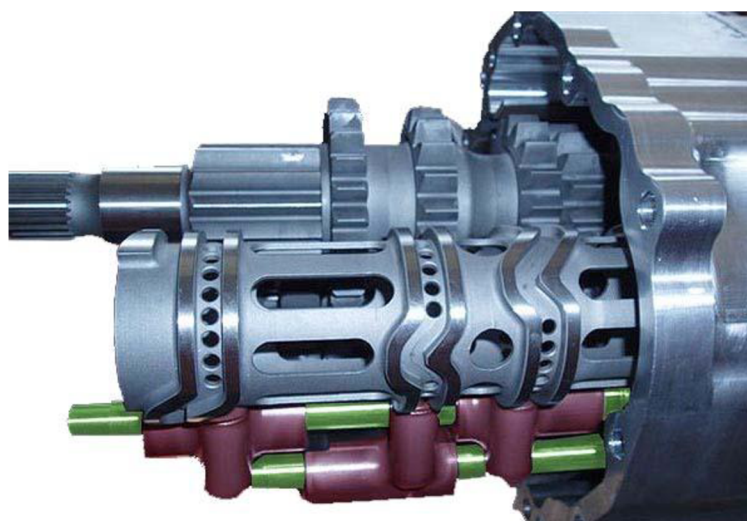
Obr. 3.18 Řadící válec převodovky Kaps Transmission [15]
