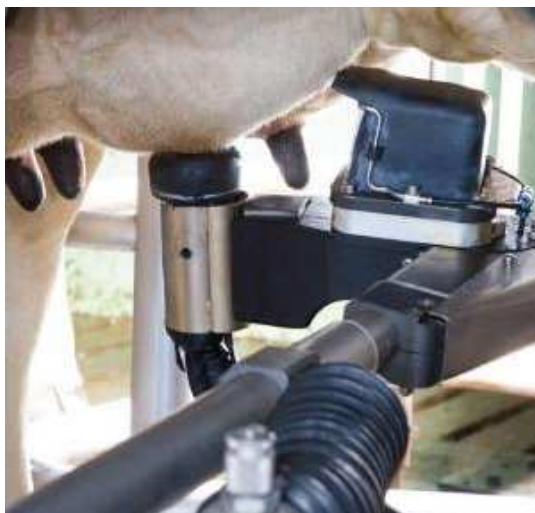
Obr. 5. Nasazování strukových násadců u VMS
