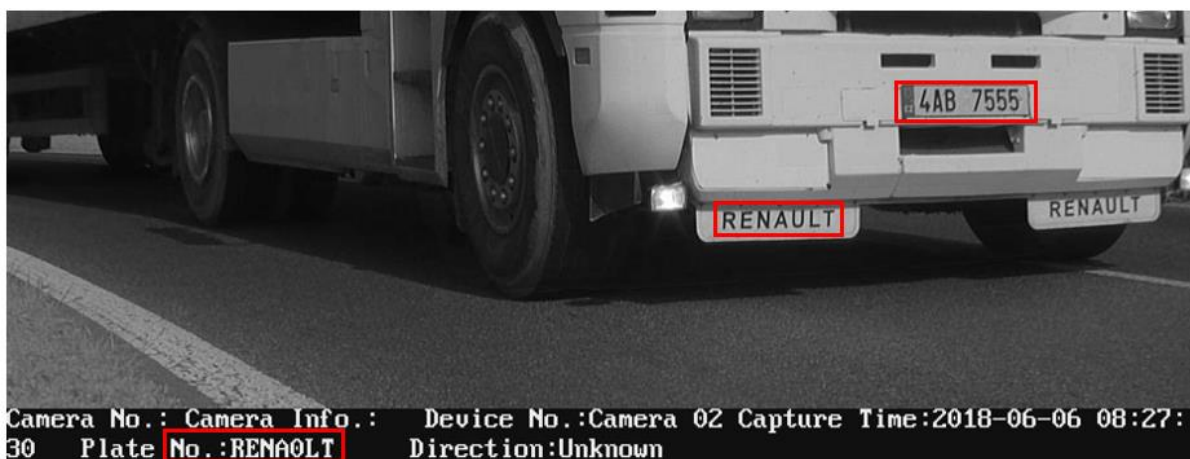
Obr. 36 IP kamera HIKVISION – chybná detekce RZ
