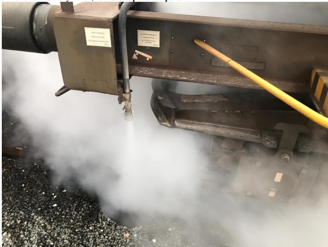
Příloha 10: Zavřený ventil, ze kterého podchází pára
