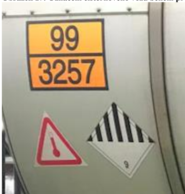
Obrázek 17: Označení cisternového vozu během přepravy asfaltu
