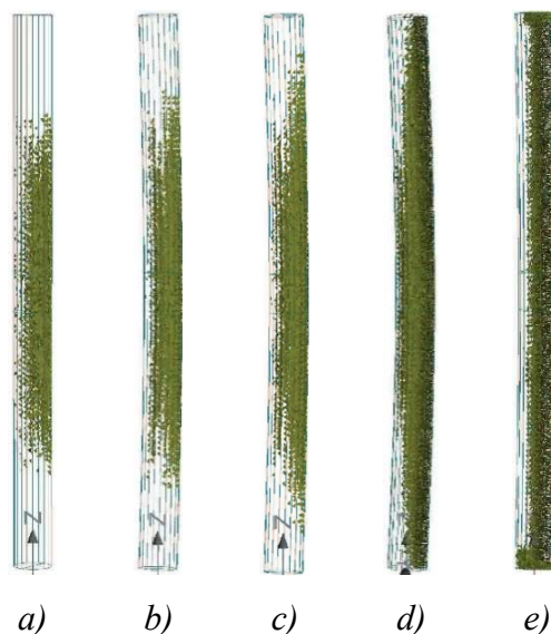
obrázek 53 - Porušení průřezu v jednotlivých režimech zatěžování – zobrazení trhlín
