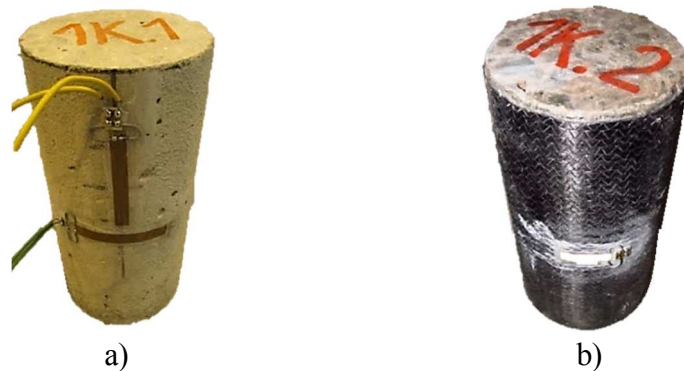
obrázek 27 - Vzorky z prostého betonu a) poloha tenzometrů na povrch betonu; b) zesílení ovinutím včetně osazení tenzometru na povrchu FRP tkaniny
