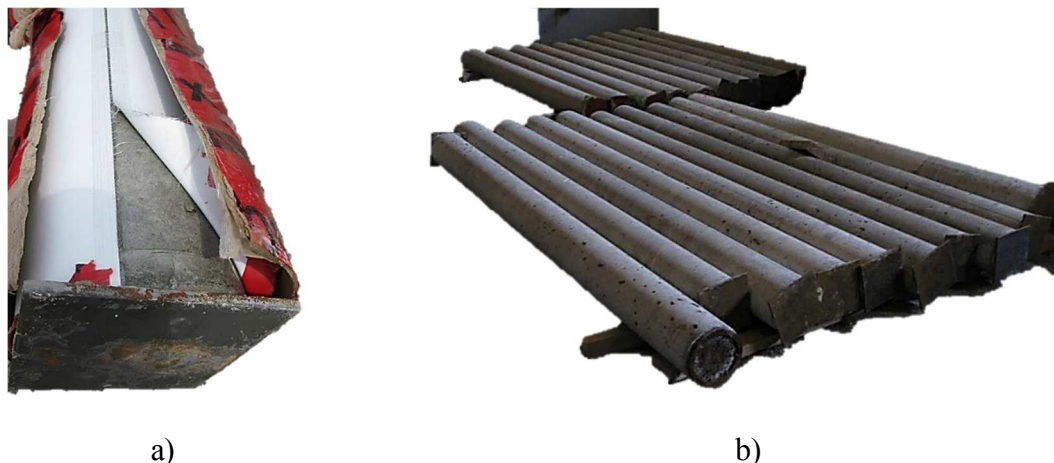
obrázek 37 - Výroba zkušebních vzorků – a) odbednění; b) pohled na vyrobené vzorky
