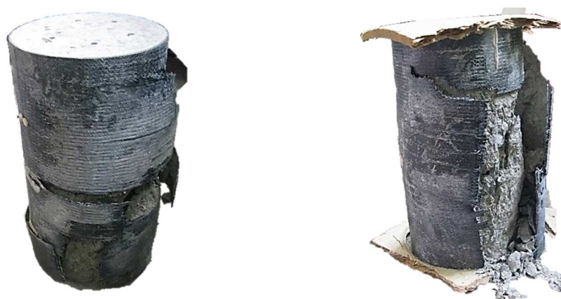
obrázek 33 - Způsob porušení zesílených vzorků krátkých železobetonových sloupů
