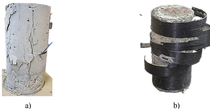
obrázek 29 - Způsob porušení krátkého sloupu z prostého betonu a) nezesílený vzorek; b) vzorek zesílený ovinutím laminátem kompozitní tkaniny
