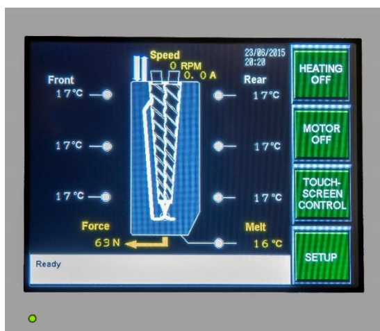
Obr. 9 Nastavení teplot Mikro kompaundéru Xplore MC 15 HT [33]
