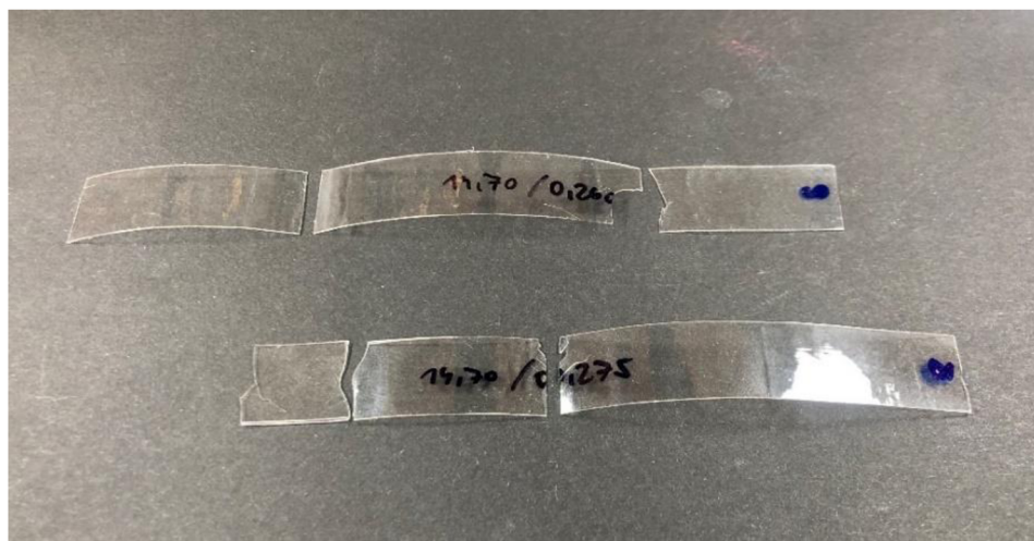
Obr. 13 Správně (mimo čelisti) přetržený vzorek po tahové zkoušce
