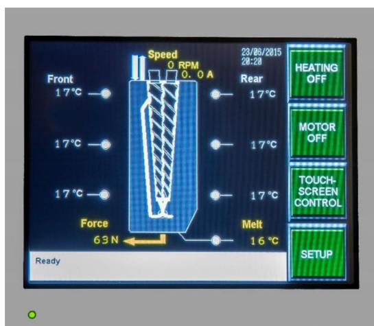
Obr. 9 Nastavení teplot Mikro kompaundéru Xplore MC 15 HT [33]
