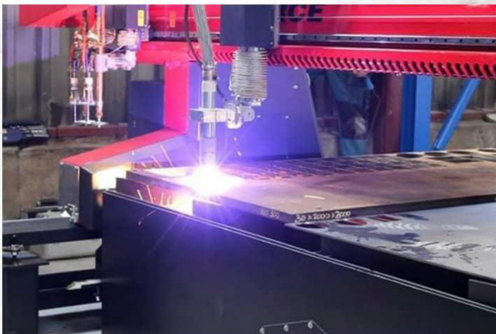
ŘEZÁNÍ PLAZMOU NA STROJI PIERCE 3000 Maximální rozměr materiálu pro zpracování 6000 x 2000 mm.
