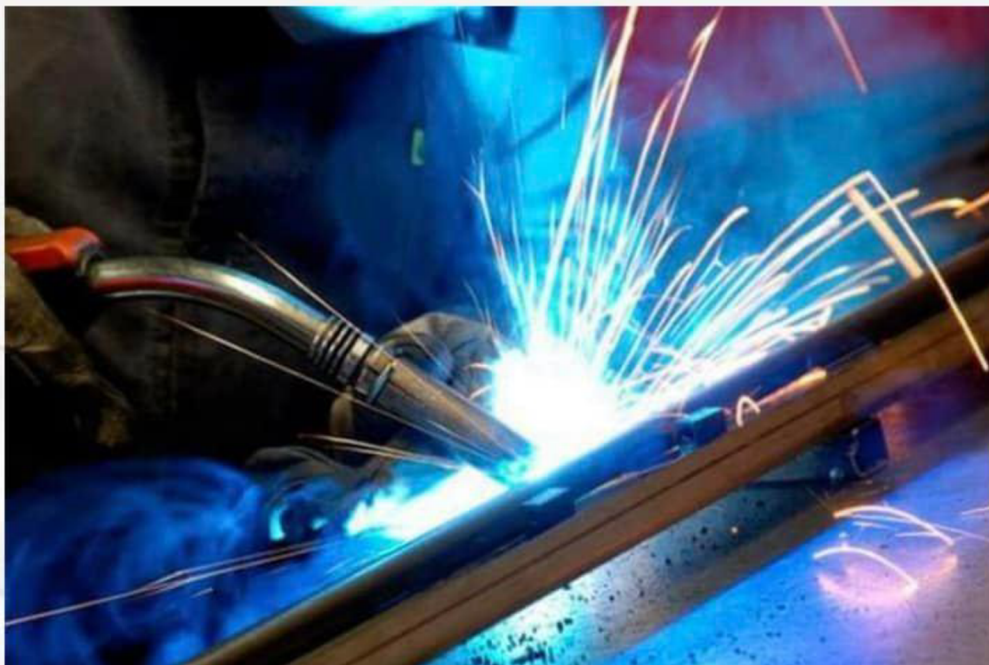
POLOAUTOMATICKÉ SVAŘOVACÍ TECHNOLOGIE PRO SVAŘOVÁNÍ V OCHRANNÉ ATMOSFÉŘE INTERNÍHO (MIG) NEBO AKTIVNÍHO (MAG) PLYNU
