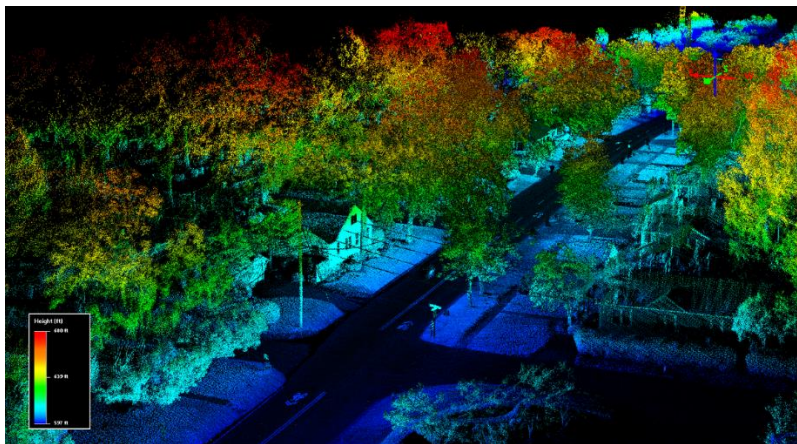
Obrázek 14 Ukázka mapování pomocí LIDAR (28)
