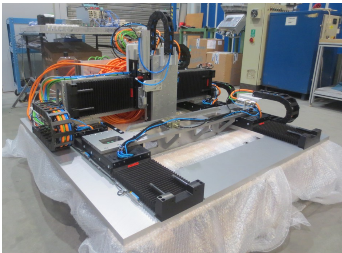
Obr. 24 Pohony s lineárními motory Hiwin
