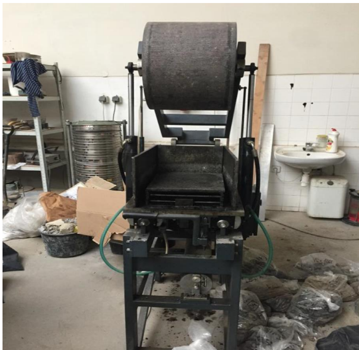
Obrázok č. 7: Hutniace zariadenie na výrobu skúšobných dosiek
