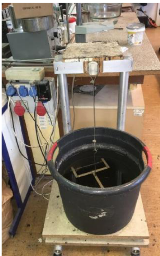
Obrázok č.5: Váženie skúšobných telies vo vode
