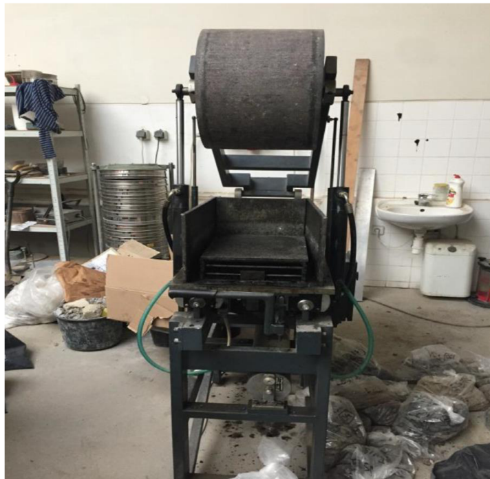
Obrázok č. 7: Hutniace zariadenie na výrobu skúšobných dosiek
