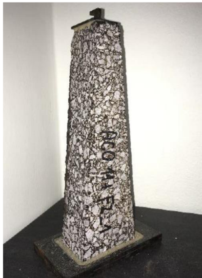
Obrázok č. 12: Skúšobne telesá – zrezané klíny
