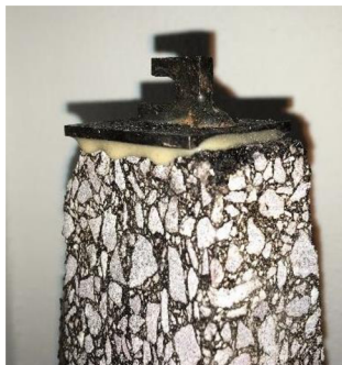
Obrázok č. 13: Detail prichytenia háčiku
