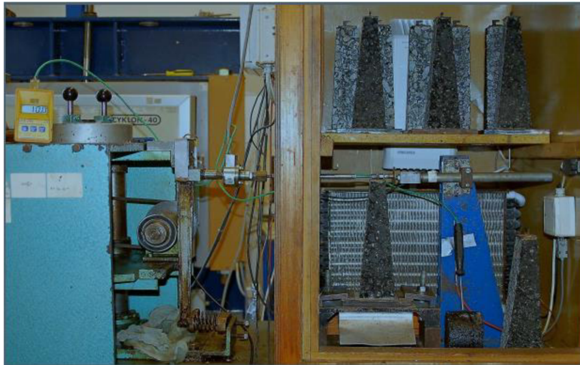
Obrázok č. 11: Zariadenie na meranie modulov tuhosti asfaltových zmesí
