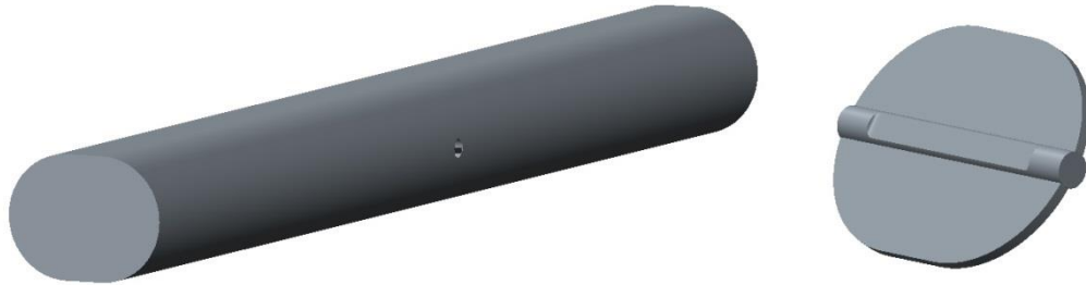
Obr. 30 Model kanálu motýlkové škrticí klapky včetně odečteného modelu elementu klapky
