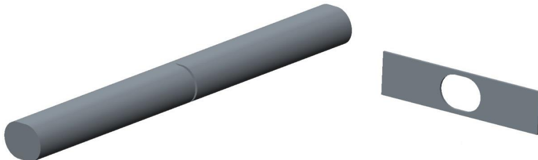
Obr. 31 Model kanálu pravítkové škrticí klapky včetně odečteného modelu elementu klapky
