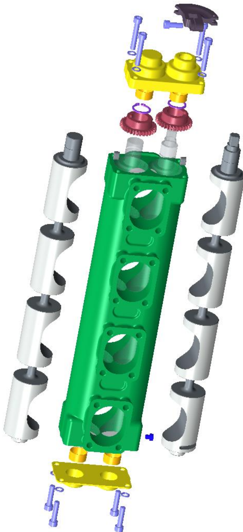
Příloha P11 3D model sestavy dvou-soudečkové škrticí klapky
