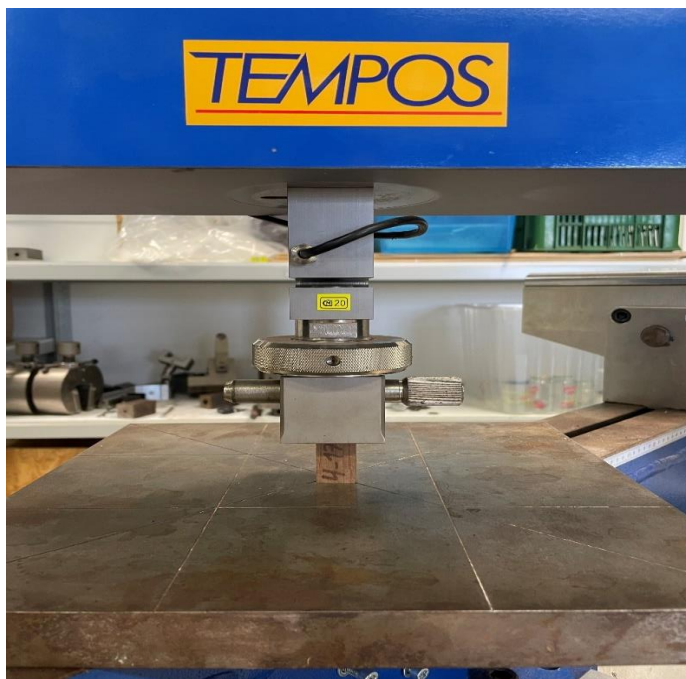
Obrázek 13 - Detail vzorku v přístroji TIRAtest 2850 (autor)
