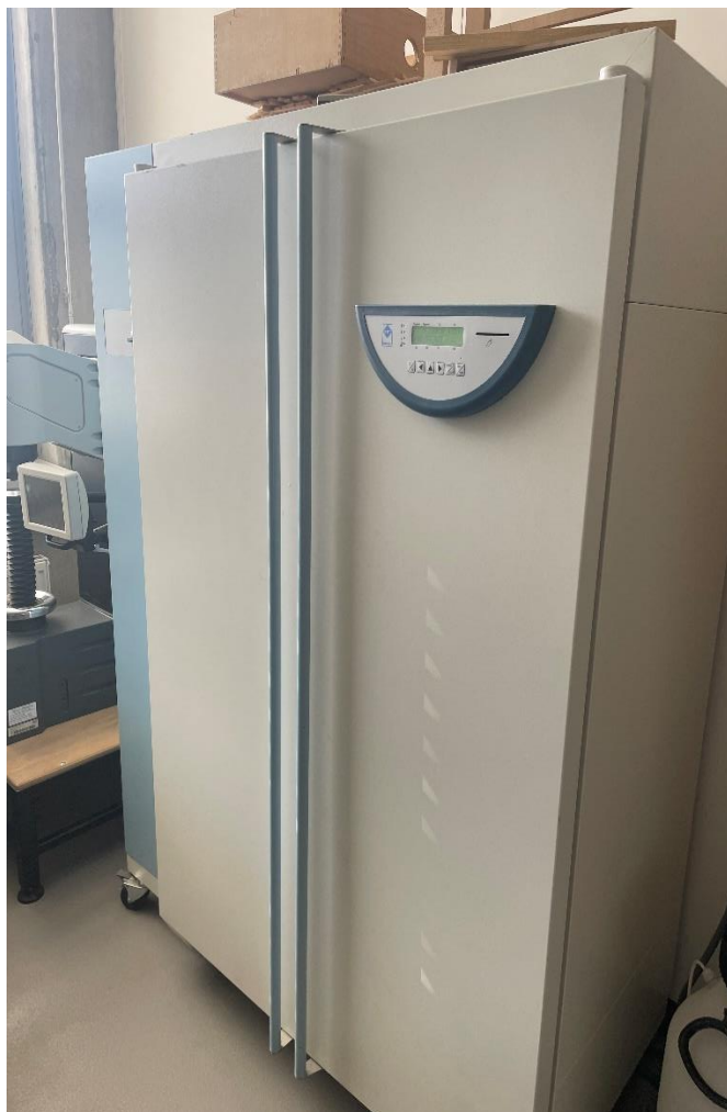
Obrázek 10 - Klimatizační komora (autor)
