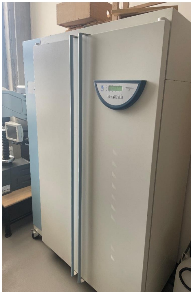
Obrázek 10 - Klimatizační komora (autor)
