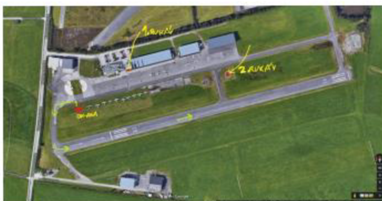
Obr. 8: Situace na letišti včetně umístění druhého větrného rukávu v blízkosti startovací dráhy
