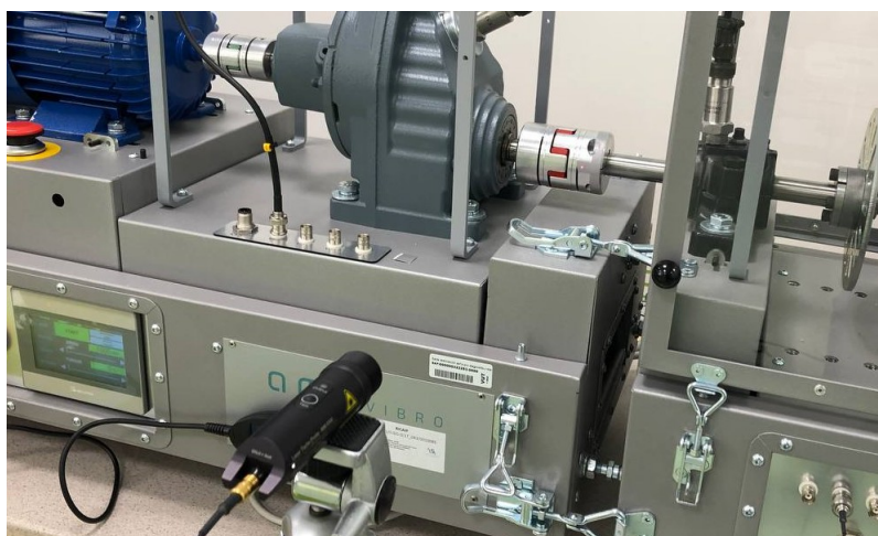
Obr. 1.3: Měření fáze pomocí optické sondy
