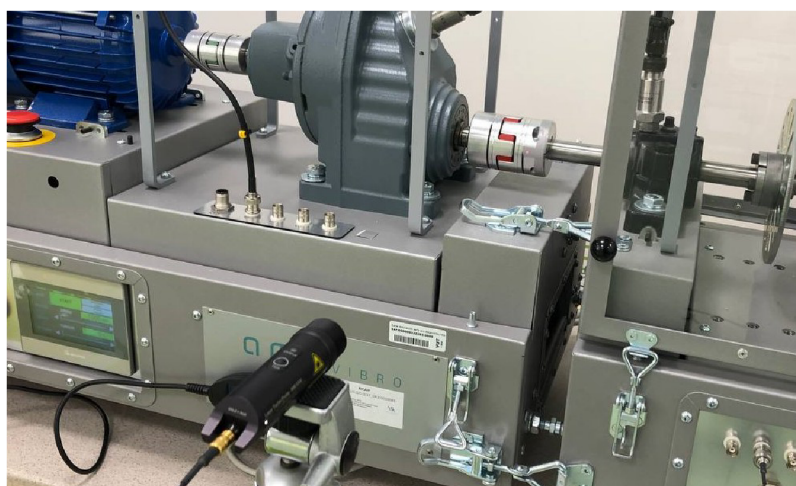
Obr. 1.3: Měření fáze pomocí optické sondy
