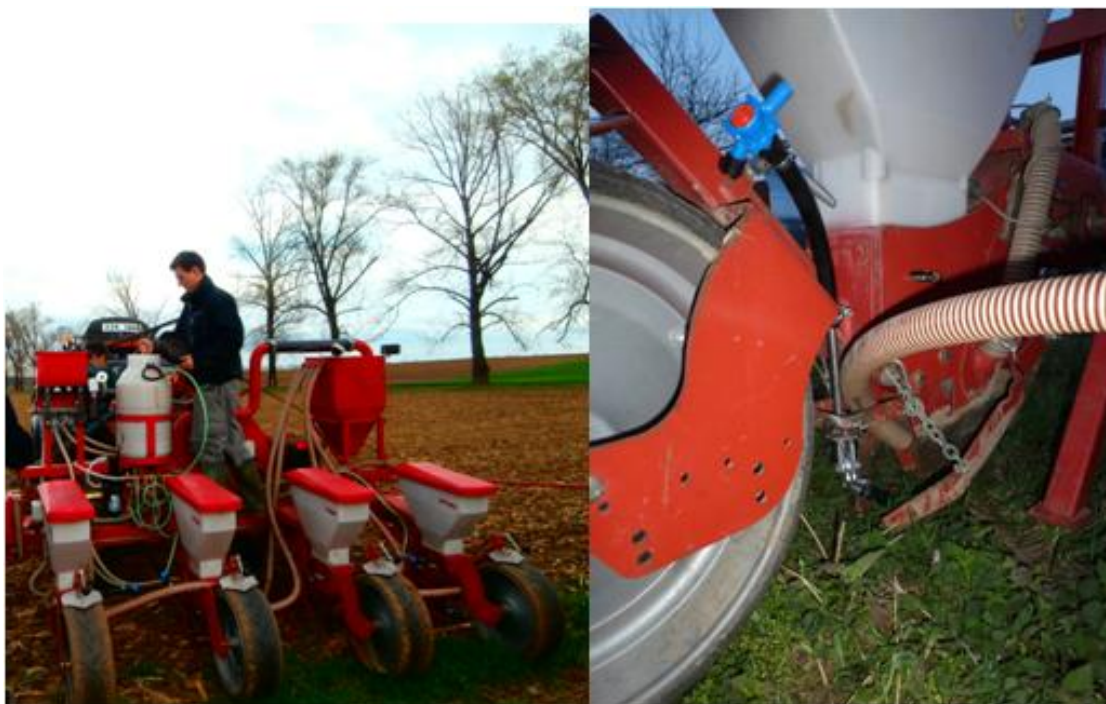
Obr. 17 Upravený secí stroj s aplikátorem na roztok hlístic (DOLEŽALOVÁ, TEPLÝ)
