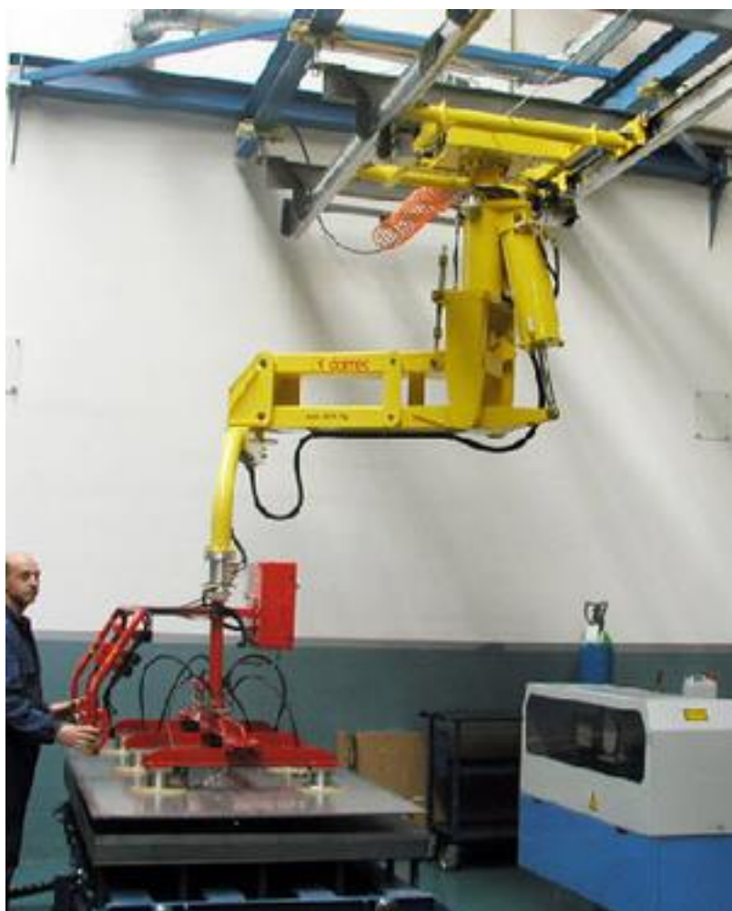
Obr. 1 Průmyslový manipulátor s pneumatickým pohonem [4]
