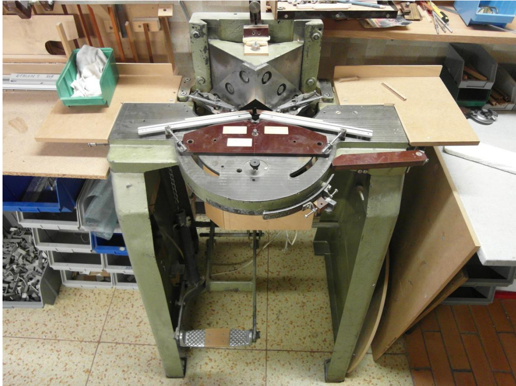
Obrázek 15 Rámařská sekačka s přípravkem k nastavení přesných úhlů
