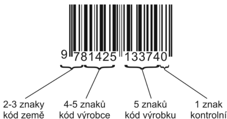
Obr. 1.9 Struktura kódu EAN 13
