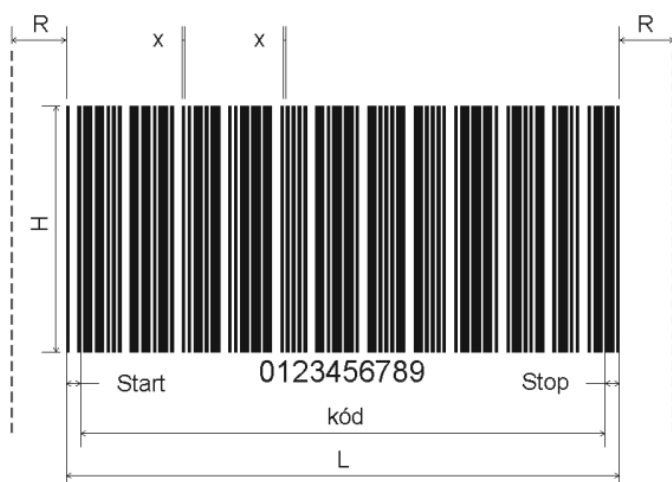
Obr. 1.3 Struktura lineárních čárového kódu
