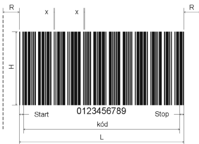
Obr. 1.3 Struktura lineárních čárového kódu
