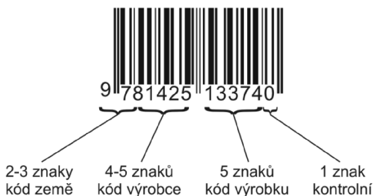
Obr. 1.9 Struktura kódu EAN 13
