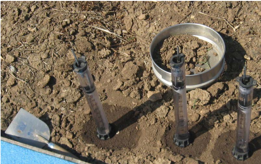
Obr. 25: Měření pomocí MDI ve 3 opakováních
