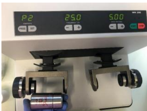
Obr. 8 Oscilační mlýn (Javůrková 2022)
