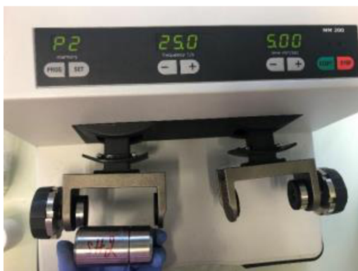
Obr. 8 Oscilační mlýn (Javůrková 2022)
