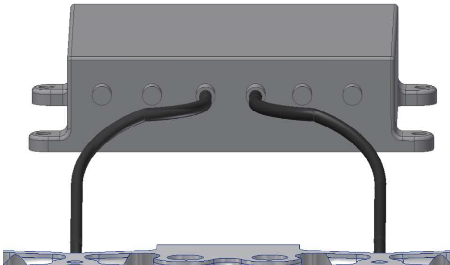
Obr.45: Čerpací LD s šestí vývodů pro optické kabely k šestiválcovému motoru TEDOM
