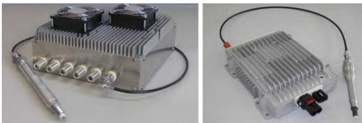
Obr.24: Dva prototypy HF regulátoru vysokofrekvenčního zapalování, typu A a B [5]
