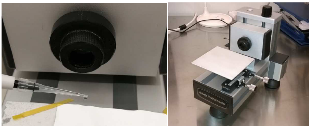
Obrázek 6.1 Nanášení destilované vody na povrch materiálu (vlevo), použité zařízení See System E Advex Instruments (vpravo).
