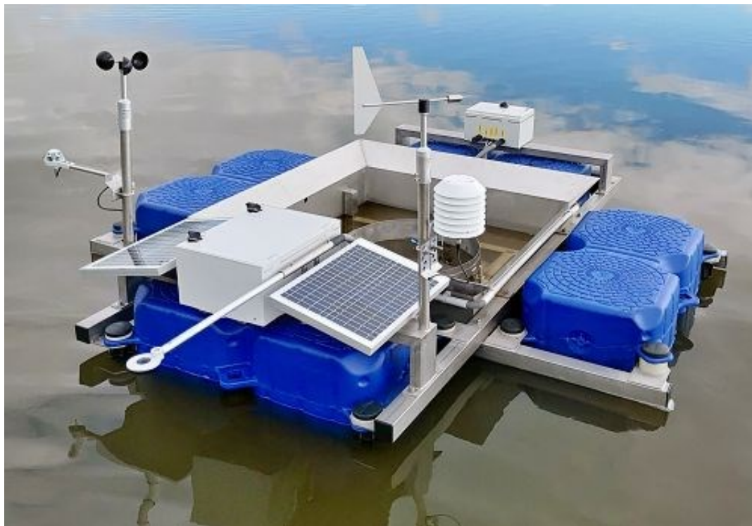
Obrázek 4 – výparoměr společnosti FIEDLER, zdroj: https://www.fiedler.company (online 2022)
