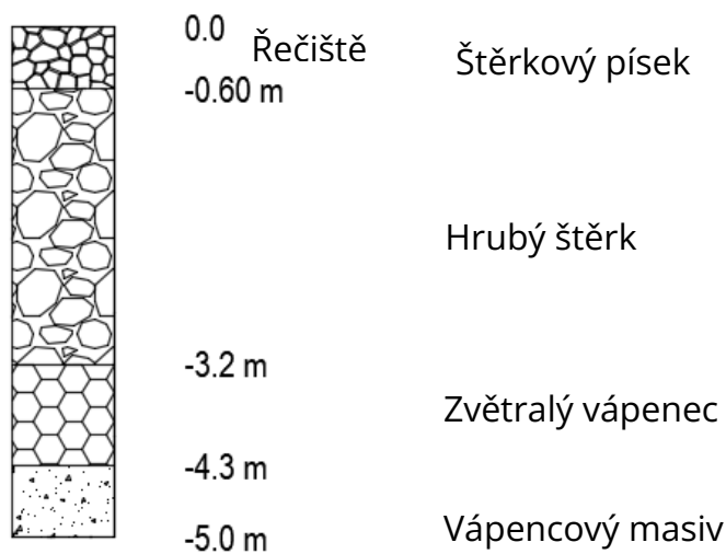
Obr. 16 – Charakteristický geologický vrt v řečišti
