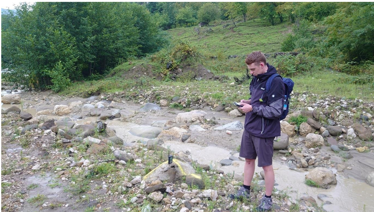
Obr. 44 – Ověřování nadmořských výšek pomocí GPS lokátoru
