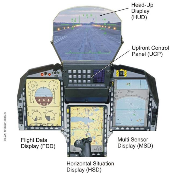
Obrázok 4.2 Displejové vybavenie kabíny Gripenu C/D [27]
