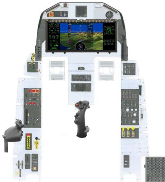
Obrázok 5.3 Kabína L-39NG s LAD od spoločnosti Collins Aerospace [50] a systémom HOTAS v usporiadaní F-35 od Wraith Systems [51]
